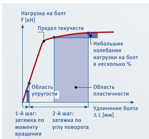
Пластическая затяжка болтов
