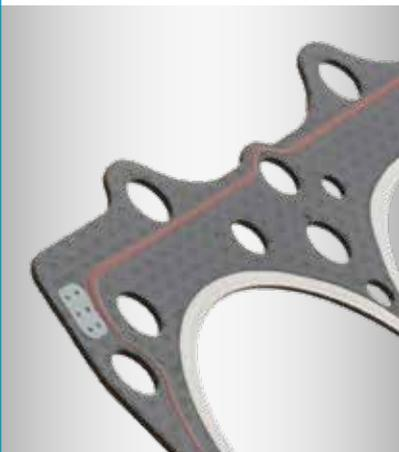
Les jointes de culasse métalliques souples d'ElringKlinger sont composées d'une couche métallique dentelée et d'une couche souple enduite des deux côtés. Ils sont destinés à la réparation des moteurs d'occasion.
