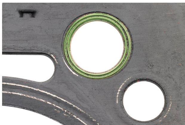
Fig. 3 : Encrassement dû au matériau d'étanchéité chimique sur le bord extérieur de l'élément d'étanchéité élastomère vert et sur la surface d'étanchéité
