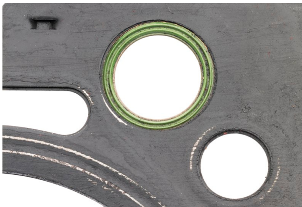
Figura 3: Impurità causate dal mastice chimico lungo il bordo esterno dell'elemento di tenuta verde in elastomero e sulla superficie di tenuta
