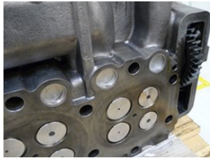
Superficie di tenuta testata del cilindro con ruota dentata cilindrica
