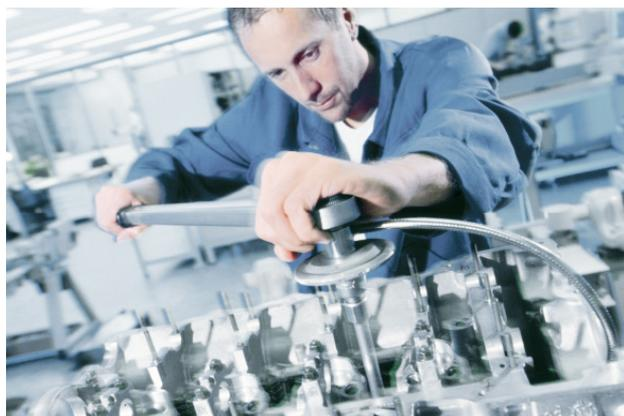
Inoltre le nuove viti della testata devono venire avvitate secondo il procedimento e la sequenza di serraggio prescritti dai costruttori del motore e della guarnizione. Il serraggio della coppia e l'angolo di rotazione previsti comporta uno sfruttamento mirato delle caratteristiche delle viti, in quanto la forza esercitata sulle viti presenta differenze molto piccole. Le viti vengono serrate oltre il limite elastico fino alla deformazione plastica.
